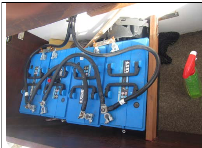
Spremište akumulatora je na otvorenom prostoru
